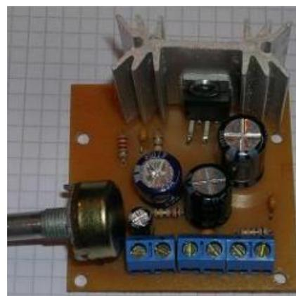
*Potenciómetro - borneras - disipador comercial*
