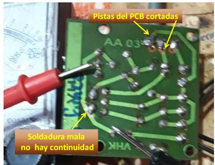
Fig. 11: Fallas en el armado del PCB
