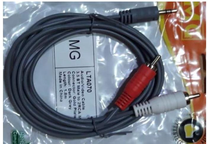
Fig. 13: Cable de audio auxiliar 3,5 mm a 2 RCA macho
