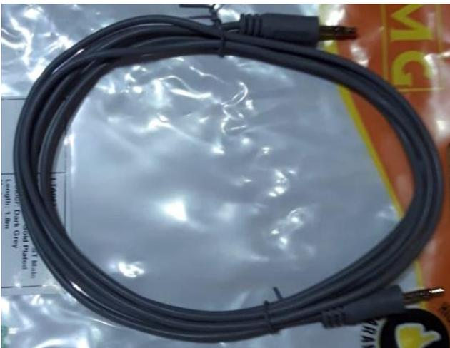
Fig. 12: Cable de audio auxiliar 3,5 a 3,5 mm estéreo
