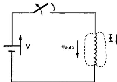
Figura 11.13. Apertura de un circuito con bobina.
