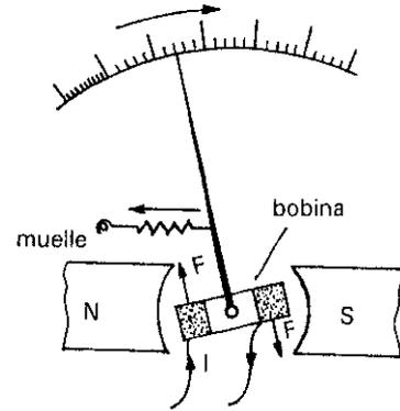
Figura 11.18. Instrumento de medida analógico.
