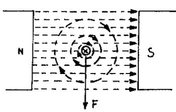
Figura 11.14. Fuerza que aparece en un conductor recorrido por una corriente eléctrica cuando está inmerso en un campo magnético.
