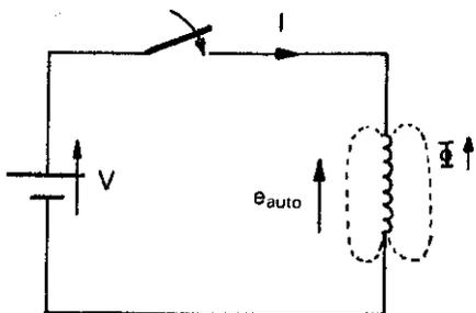
Figura 11.12. Cierre de un circuito con bobina.
