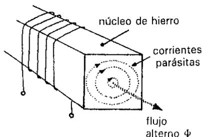
Figura 11.8. Corrientes parásitas en un núcleo de hierro macizo sometido a campos magnéticos variables.
