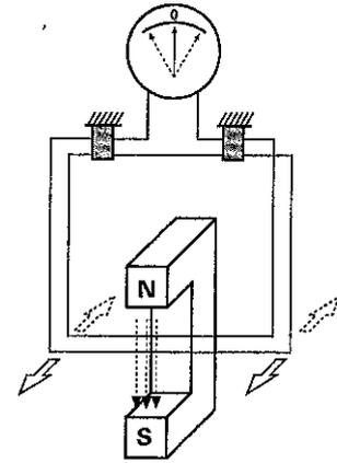
Figura 11.3. Montaje para realizar la experiencia de Faraday.
