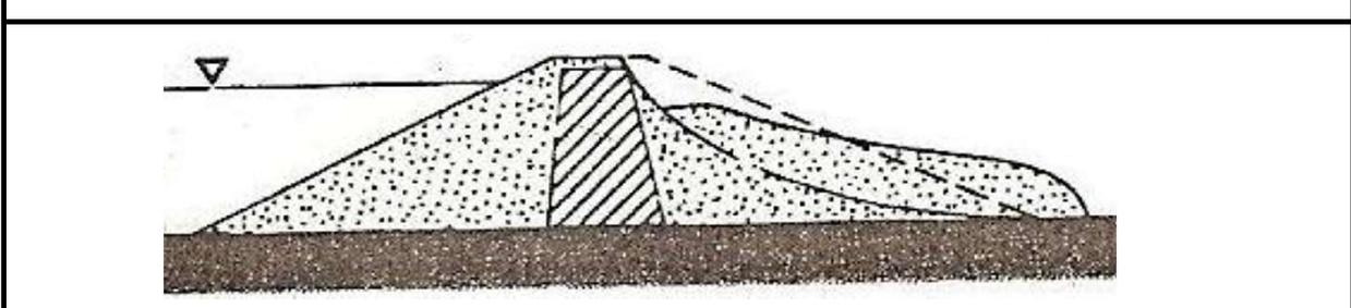
e- Inestabilidad del paramento aguas arribas: Se presenta un cambio de morfología. Se debe a un descenso rápido del nivel de agua. Un desembalse rápido quita una fuerza estabilizante (peso del agua) y el tiempo no es suficiente para la disipación de las presiones neutras. Consecuencia: disminuye resistencia al corte y colapsa el talud.
