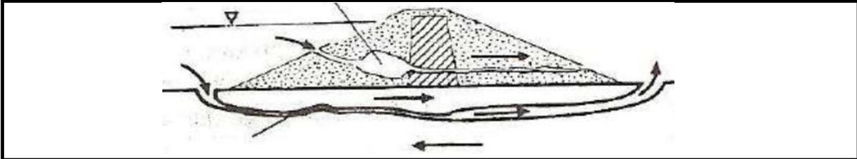
c- Sedimentación de la cimentación: Se trata de la sedimentación de largo plazo de la presa previsible en una cimentación compresible.
