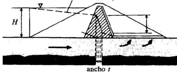
c. *Rastrillo del tipo diafragma delgado*: Se forma mediante la excavación, en longitudes de tramos de una zanja angosta estabilizada con lechadas que luego se rellenan de modo permanente con una mezcla de arcilla, arena y bentonita. Es muy efectivo en suelos de aluviones y de grano más fino y puede construirse de manera económica a profundidades de más de 30-40 m.
