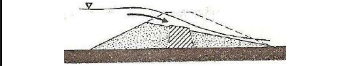
b- Infiltración: La infiltración dentro y debajo del relleno produce erosión interna oculta por la infiltración turbia a través del sistema de drenaje, y la migración de materiales finos. Para prevenir esta falla los gradientes hidráulicos, la presión de infiltración y las velocidades de infiltración dentro y bajo la presa deben restringirse a niveles aceptables.
