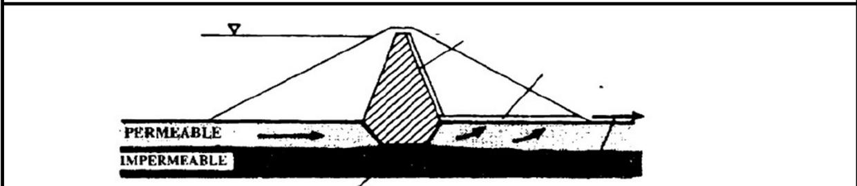
b. *Rastrillo zona inyectada*: el rastrillo se forma por inyecciones paralelas espaciadas cada 2-3 m, siendo útil para cubrir grandes profundidades hasta el manto rocoso (hasta 100m) produce una gran pérdida de carga a través del rastrillo a cambio de un elevado costo constructivo.
