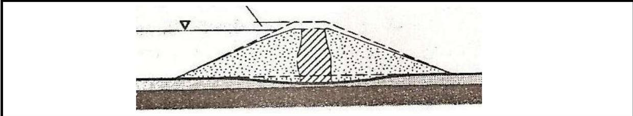
d- Inestabilidad del paramento aguas abajo: El relleno, incluida su cimentación, debe ser estable bajo la construcción y en todas las condiciones de operación del embalse. En la imagen se puede observar una erosión del pie de presa. Se puede deber a un canal del vertedero mal diseñado y/o localizado.
