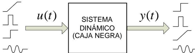
**Figura 1 – Descripción entrada-salida de un sistema dinámico SISO LIT.**
