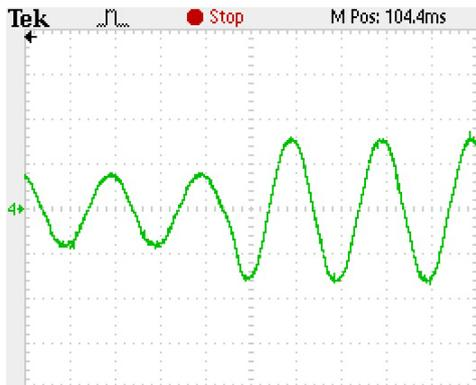
Figura 4-Corriente en la fase A, para la misma condición de la Figura 3. Escala de tiempo 10ms/div. Escala de corriente 13A/div.
