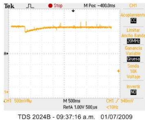
Figura 6: Respuesta transitoria de la salida o tensión controlada, v_o(t) para entrada de carga nominal.
