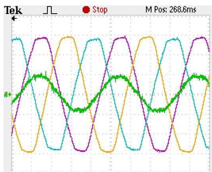
Figura 4-Corriente en fase a y tensiones de fase. Escala de tiempo 5 ms/div. Escala de corriente 2 A/div. Escala de tensión 10 V/div.
