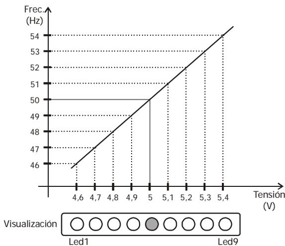
Figura 2: Relación Frecuencia-Tensión-LEDs.
