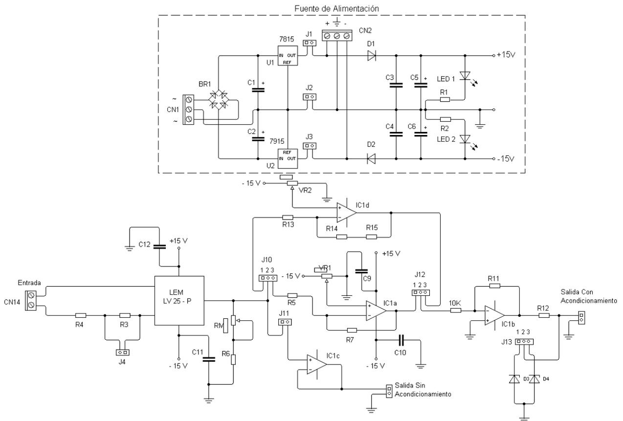
Figura 3 – Circuito esquemático de la placa acondicionadora
