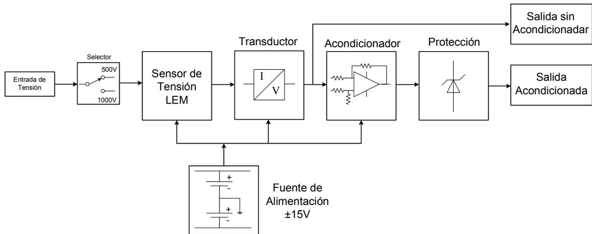
Figura 2 – Diagrama en bloques de la placa acondicionadora
