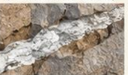
Con relleno (resistencia reducida)
