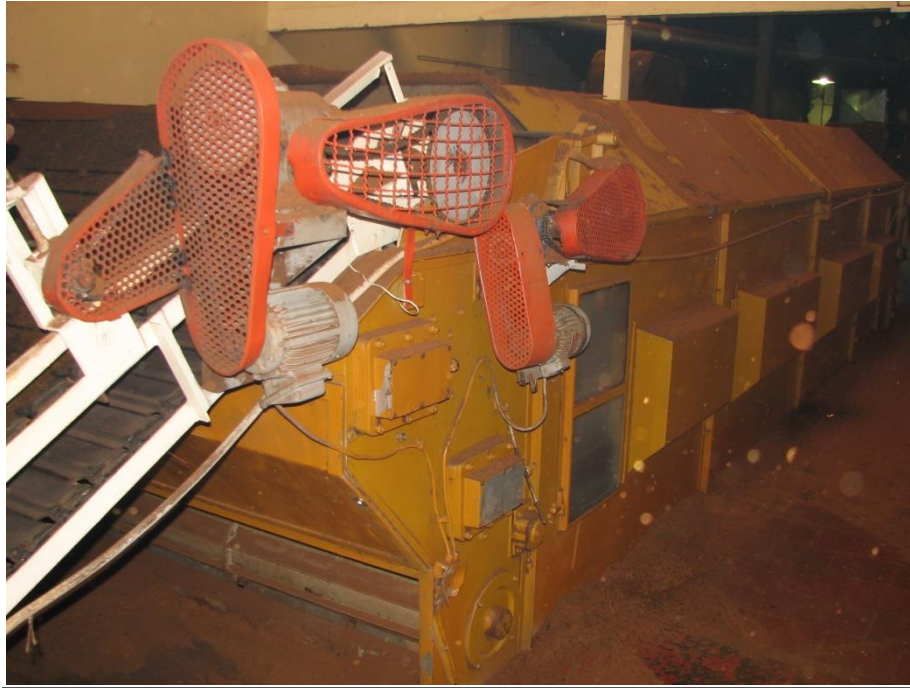
Horno para secado del té
