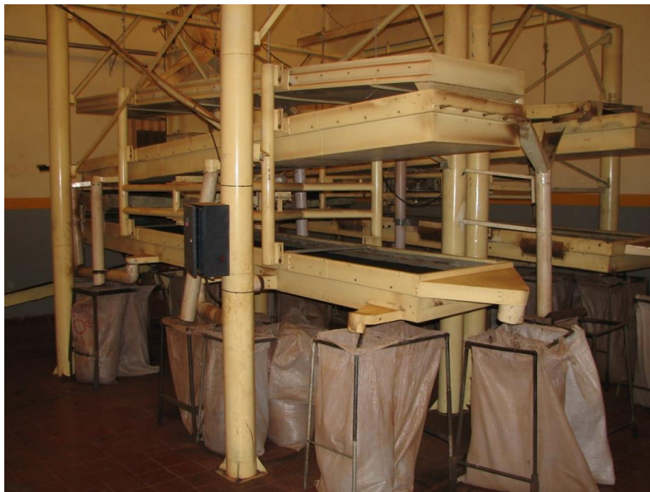
Máquina tipificadora (zaranda rotativa)
