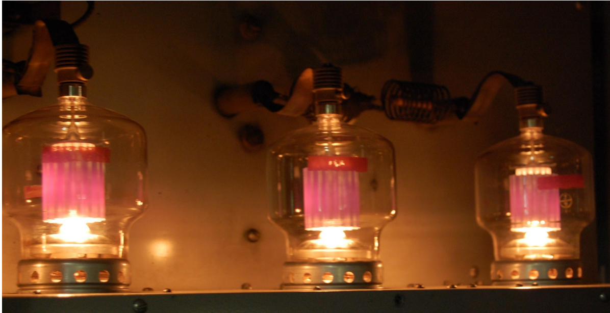
Válvulas de una estación transmisora de AM de 25 KWatt. (AM 580 radio universidad UNC)
