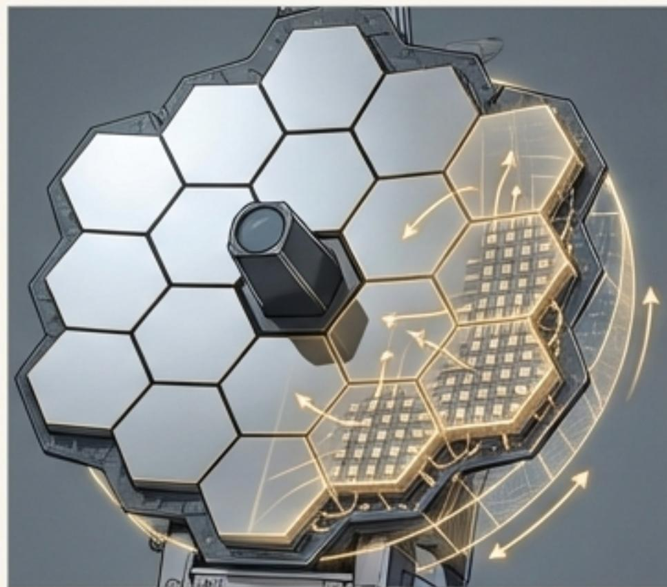
En telescopios, cientos de actuadores piezoeléctricos deforman sutilmente los espejos en tiempo real para corregir distorsiones atmosféricas, logrando imágenes de una nitidez asombrosa.
