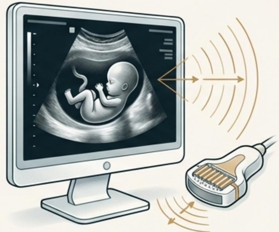
Los transductores piezoelectrados emiten y reciben pulsos de ultrasonido para generar imágenes en tiempo real de órganos y fetos, siendo una herramienta de diagnóstico fundamental y segura.
