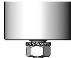
Aterramento do capacitor parafuso M12
