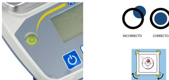
**Figura 15** (Nivel de burbujas y nivelación de la balanza a emplear)
