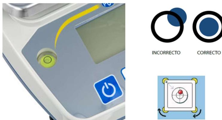
**Figura 16** (Nivel de burbujas y nivelación de la balanza a emplear)
