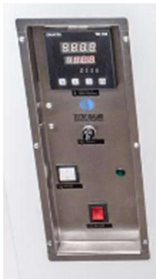
*Figura 11* (Ejemplo de modo de regulación de temperatura de un horno)
