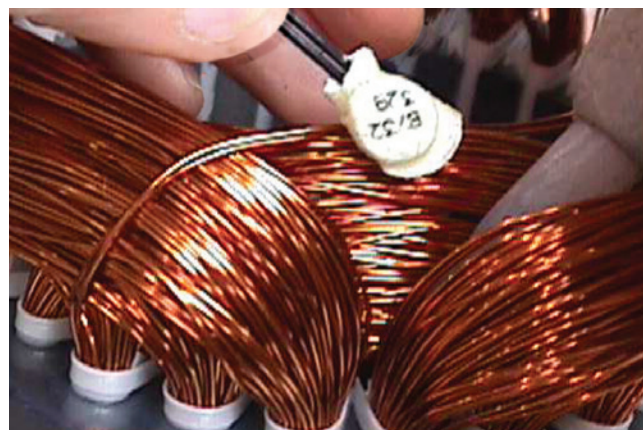
Figura 7.6 - Instalación del protector térmico bimetálico.
