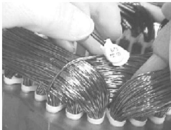
Figura 5.5 - Instalação do termostato na cabeça da bobina
