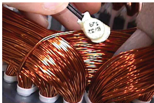
Figura 7.6 - Instalação do protetor térmico bimetálico
