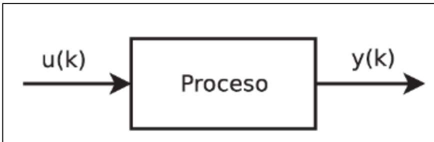
Fig. 1: Representación de un sistema o proceso de una entrada y una salida [1].
