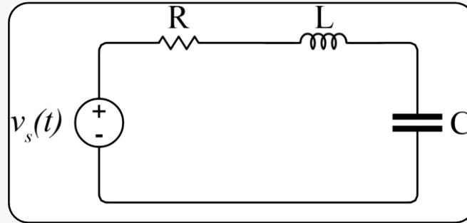
Hallar a ecuación integro-diferencial (en función de la corriente del circuito  $i$ ) o diferencial (en función de la carga  $q$ ) del circuito RLC. Para la resolución se debe tener en cuenta la ley de Kirchhoff.
