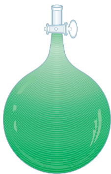
Figura 5.12 Aparato para medir la densidad de un gas. Un bulbo de volumen conocido se llena con el gas bajo estudio a cierta temperatura y presión. Primero se pesa el bulbo, y después se vacía (evacua) y se vuelve a pesar. La diferencia en las masas proporciona la masa del gas. Si conocemos el volumen del bulbo, podemos calcular la densidad del gas. En condiciones atmosféricas, 100 mL de aire pesan alrededor de 0.12 g, una cantidad fácilmente cuantificable.
