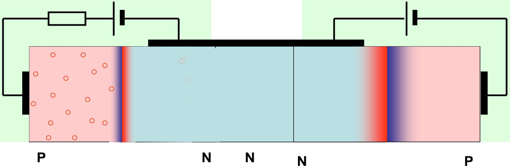
**Si la zona central es muy ancha, el comportamiento es similar a dos diodos en oposición. El funcionamiento de la primera unión no afecta a la segunda.**
