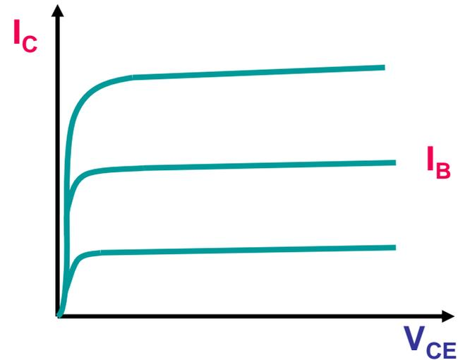
La corriente que circula por el colector se controla mediante la corriente de base  $I_B$ .
