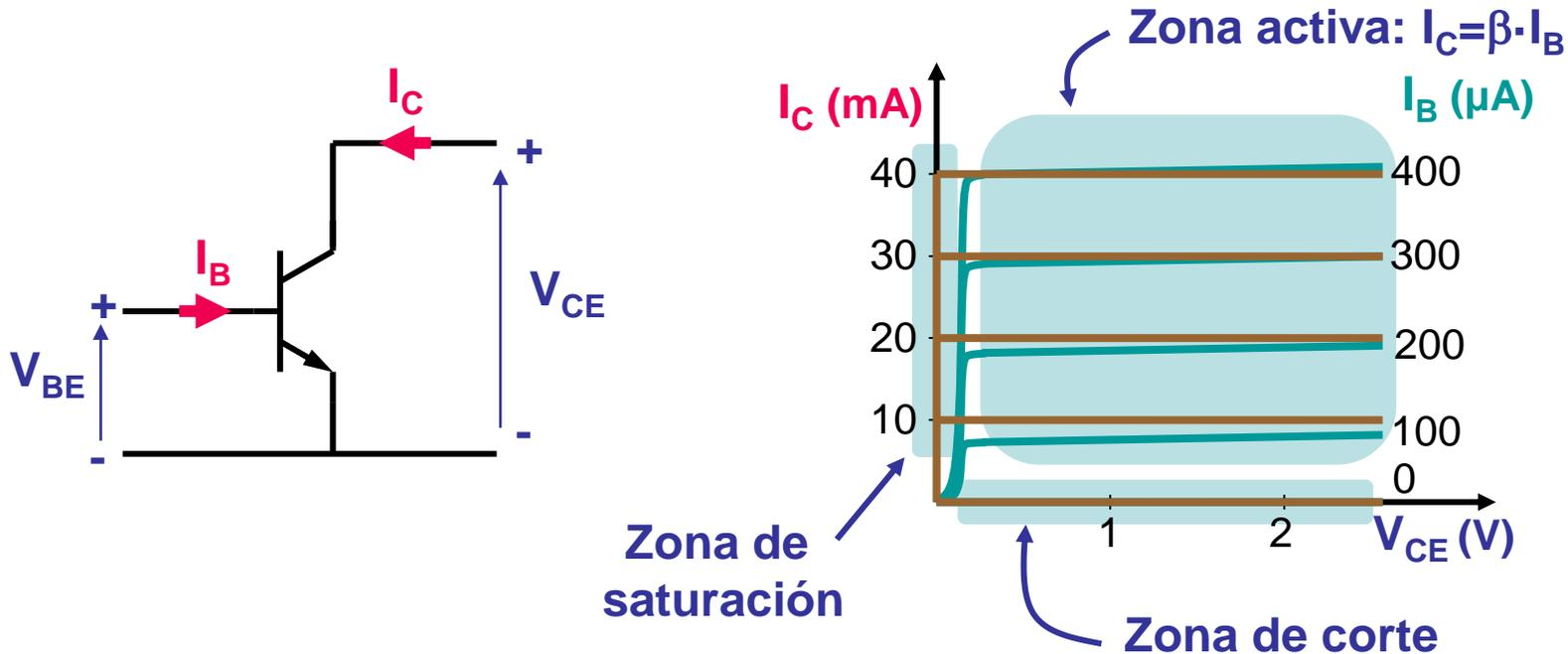
El parámetro fundamental que describe la característica de salida del transistor es la ganancia de corriente  $\beta$  ( $h_{fe}$ ).
