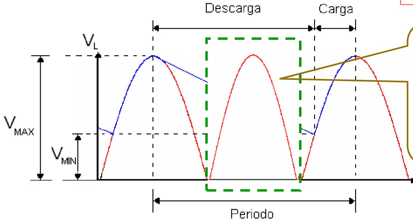
En rectificación de onda completa aparece una nueva semionda >
