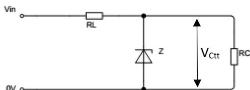
Fig 1.a: circuito regulador de tensión con diodo Zener en paralelo con la carga
