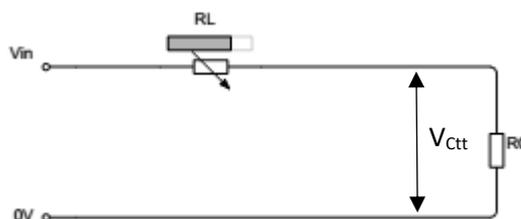
Fig 2.b: circuito regulador de tensión con resistor variable en serie con la carga
