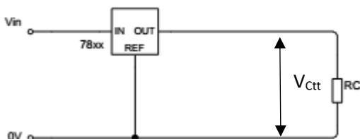
Fig 2.a: circuito regulador de tensión con CI en serie con la carga
