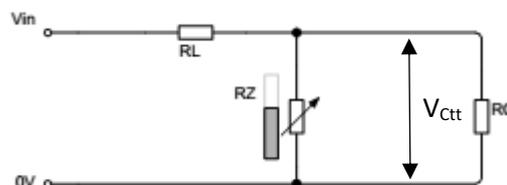
Fig 1.b: circuito regulador de tensión con resistor variable en paralelo con la carga
