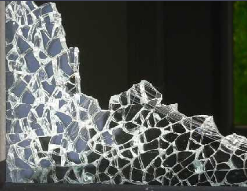
Rotura de un vidrio templado.
