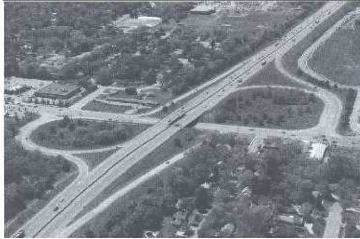
Figura 10-30. Distribuidor de cuatro ramales (Trébol parcial o dos cuadrantes con ramas antes de la estructura principal)
