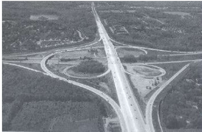
Figura 10-41. Distribuidor de cuatro ramales, Trébol con una conexión semidirecta
