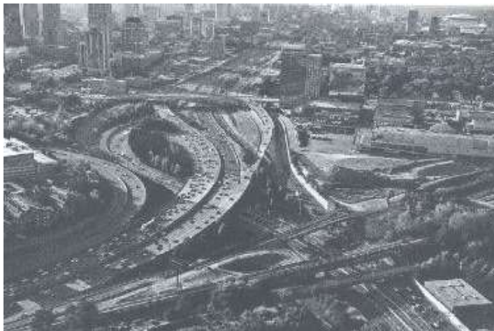
Figura 10-43. Disposición de distribuidor complejo
