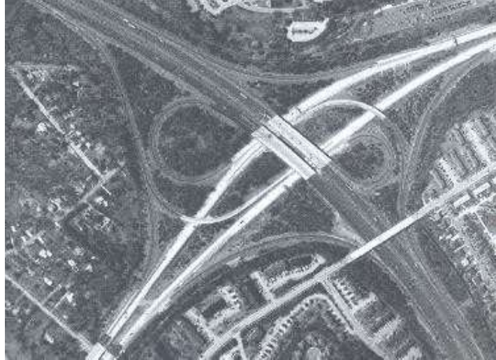
Figura 10-38. Distribuidor de trayecto con conexión semidirecta y rulos Fuente: Maryland SHA
