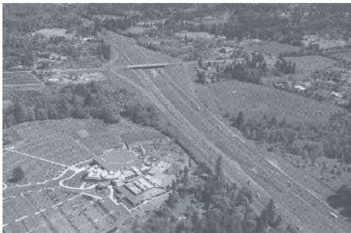
Figura 10-16. Típico distribuidor diamante de cuatro ramales Fuente: Oregón DOT
