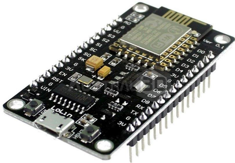
Chip de bajo costo con capacidad de comunicación WiFi, basado en un CPU RISC de 32-bit: Tensilica Xtensa LX106.
