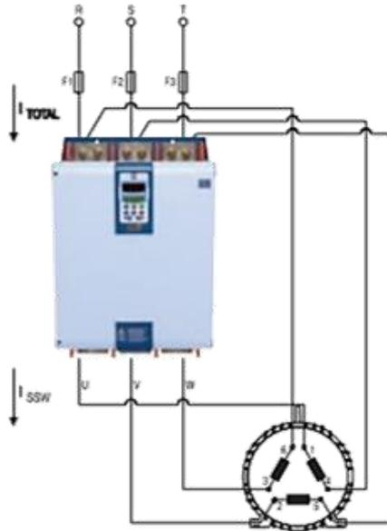
Arrancador Suave Dentro del Triángulo del Motor
