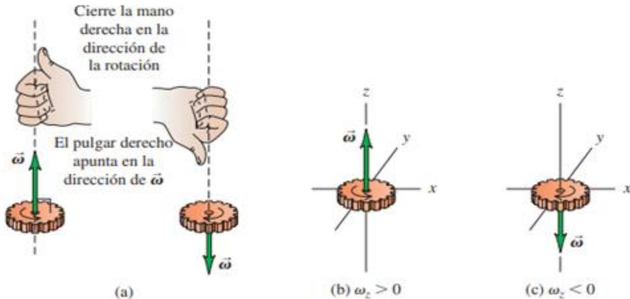
(a) Regla de la mano derecha para determinar la dirección del vector de velocidad angular  $\vec{\omega}$ . Si se invierte el sentido de la rotación se invierte la dirección de  $\vec{\omega}$ . Si la rotación es sobre el eje  $z$ , el signo de  $\omega_z$  dependerá de si  $\vec{\omega}$  apunta (b) en la dirección  $+z$  o (c) en la dirección  $-z$ .
