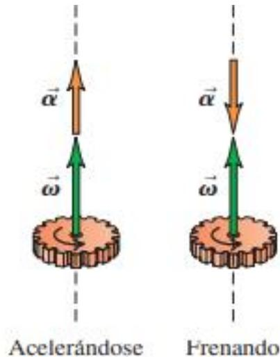
Cuando el eje de rotación es fijo, los vectores de aceleración angular y velocidad angular están sobre ese eje.
