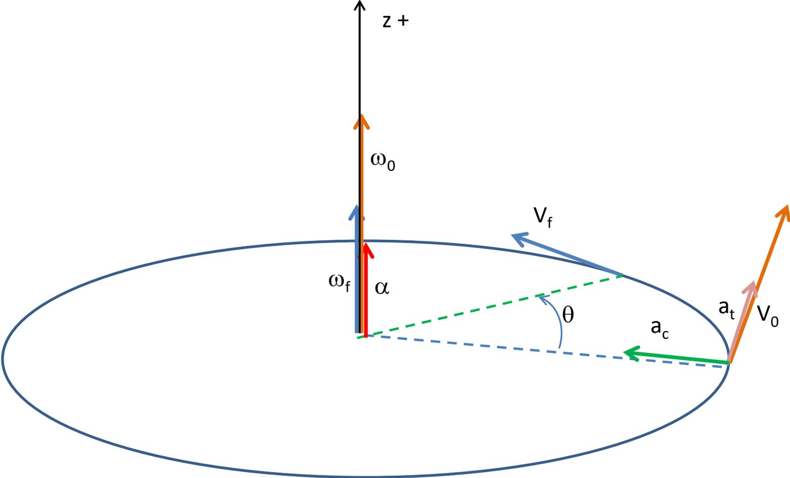
**Ejercicio N° 11:** Si en 10 segundos un plato de 1 metro de diámetro deja de girar luego de dar 300 vueltas debido a la aplicación de un frenado constante. Determinar y representar gráficamente:
