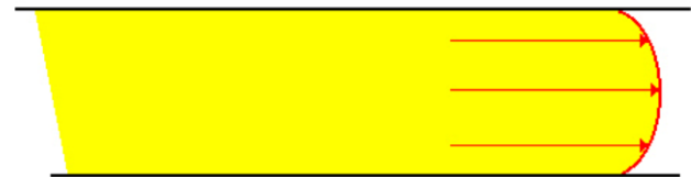
Un acondicionador de flujo elimina los remolinos y genera un perfil
