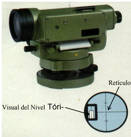
Nivel de anteojo llamado nivel de línea por tener tornillo de cabeceo para centrar el nivel tórico.
