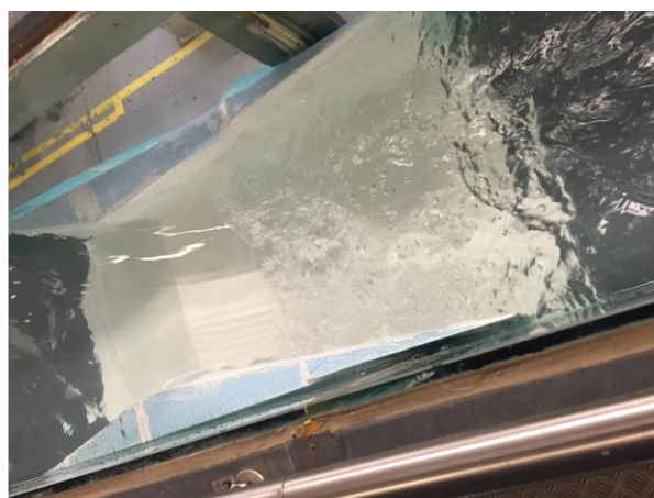
Ensayo en laboratorio. Resalto tras paso del fluido por vertedero contraído. Tesina Antonio R Morales.
