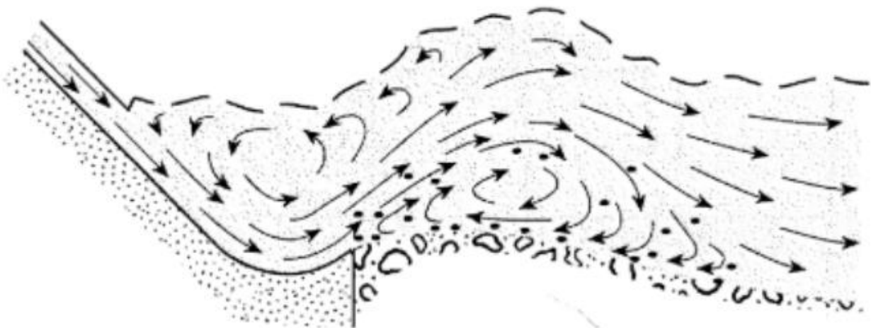
Esquema de trampolín sumergido Gráfico: SPANCOLD. Guía Técnica 5. Aliviaderos y desagües
