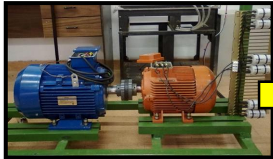
Motor + Generador (Microturbina + Generador)
