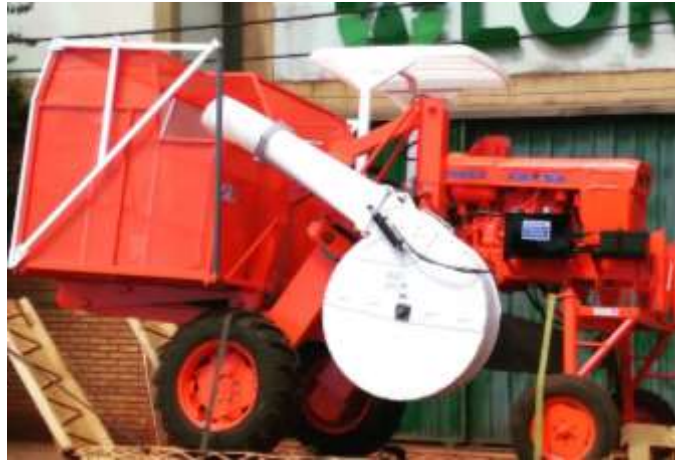
Figura 13: Cosechadora de té Fiat 400. Fuente: web Lory Maquinas
