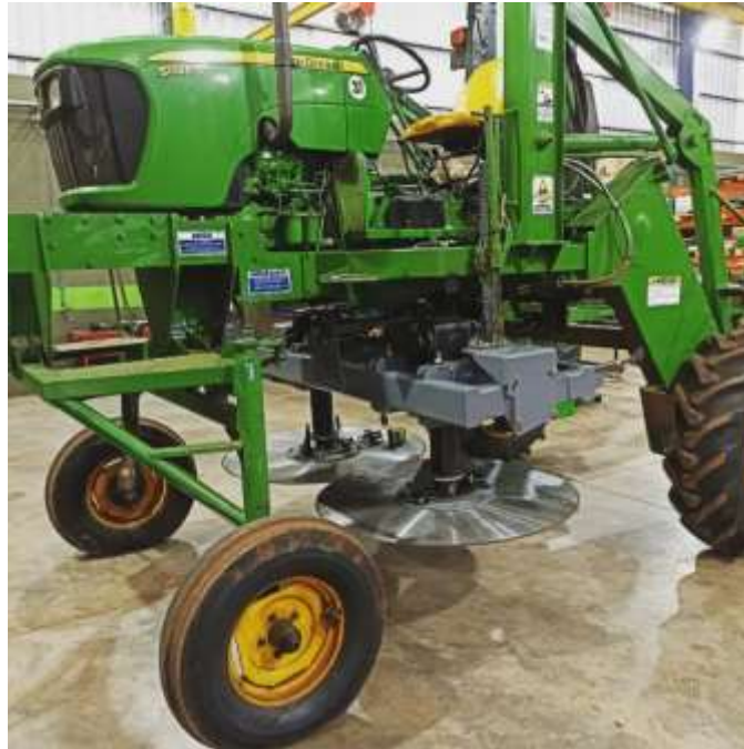
Figura 17: Rebajadora para cultivos de té. Fuente: web Lory Maquinas
