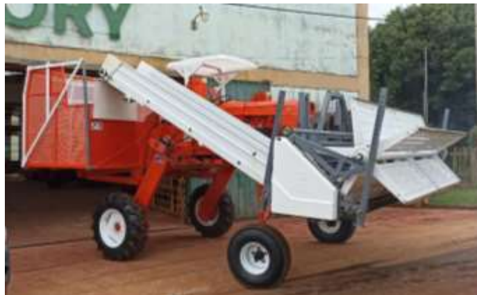
Figura 9: Cosechadora yerba mate fiat 400. Fuente: web Lory Maquinas
