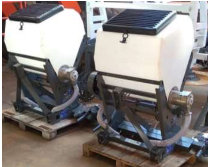
Figura 14: Abonadora para cultivo de yerba mate. Fuente: web Lory Maquinas
