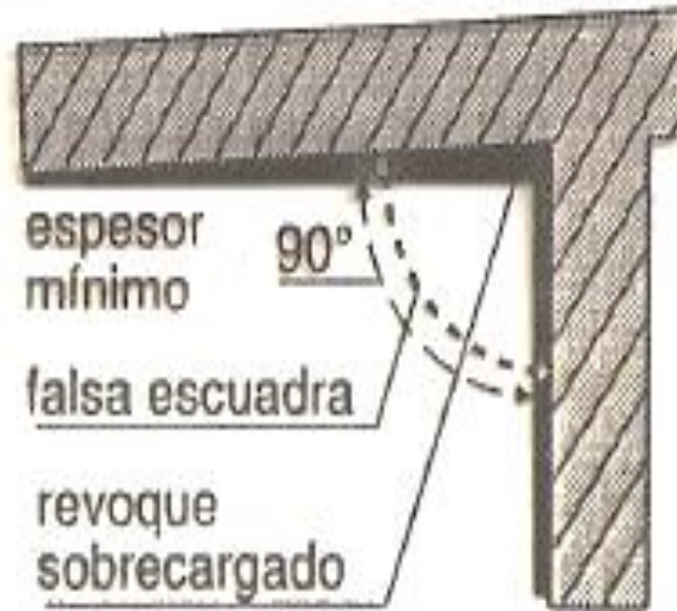
pared mal ejecutada
