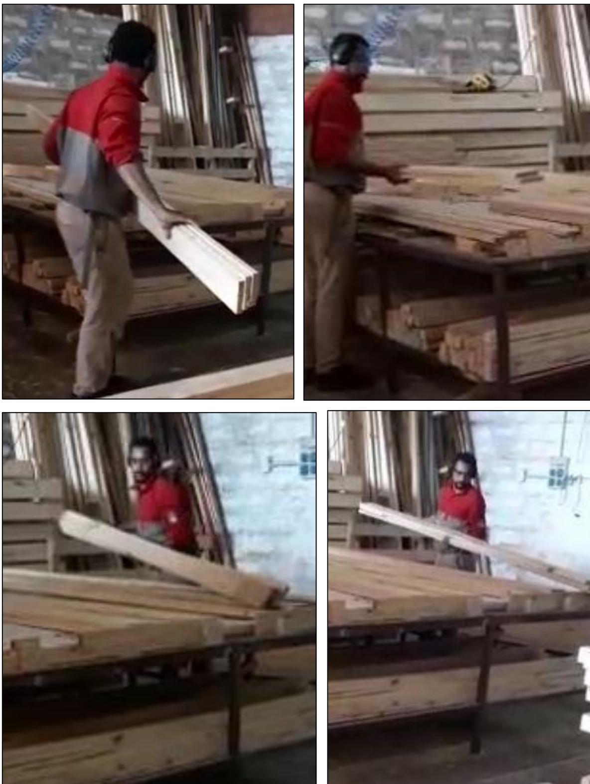
**Fig 1.** Traslado y ubicación de tablas de pino en mesa de ensamble
