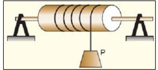
13) Se desea bajar una carga de 420 N utilizando una cuerda de masa despreciable a través de una polea de 25 cm de radio y 18 kg de masa. Se pretende bajar la carga 8 m desde su posición de reposo en 2 s. Realizar el diagrama de cuerpo libre en la polea y en la carga, así como el diagrama de torque en la polea. Además, determinar:
