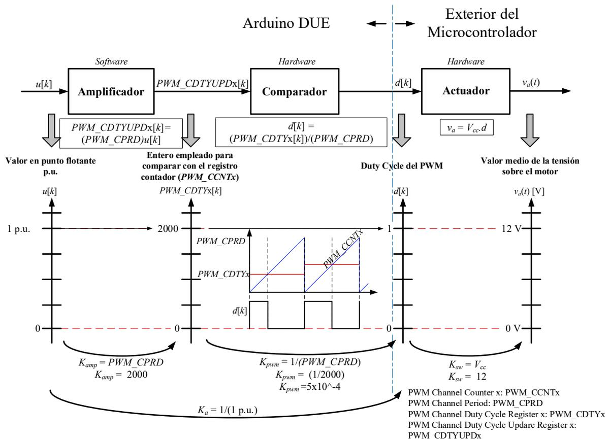
Figura 4: Detalle del módulo PWM y del actuador empleado en el control del motor.
