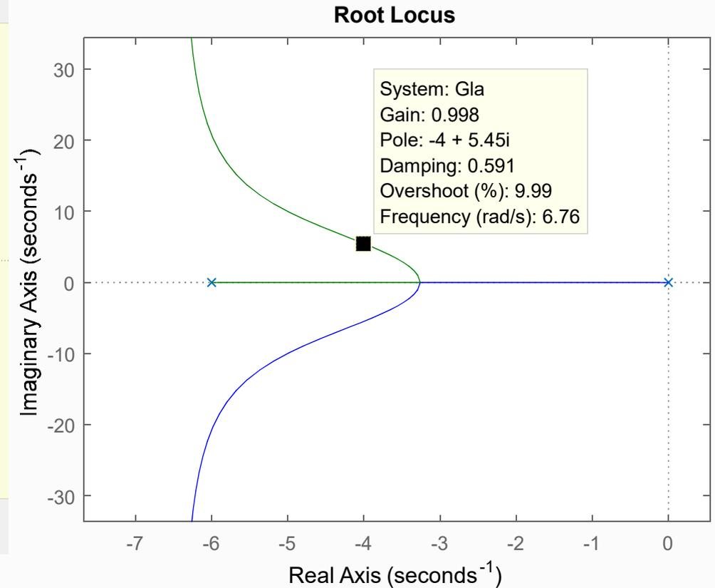
**El punto deseado pertenece al LGR del sistema compensado dado que cumple con la condición de fase y por la tanto permite que se cumplan las especificaciones de desempeño.**
