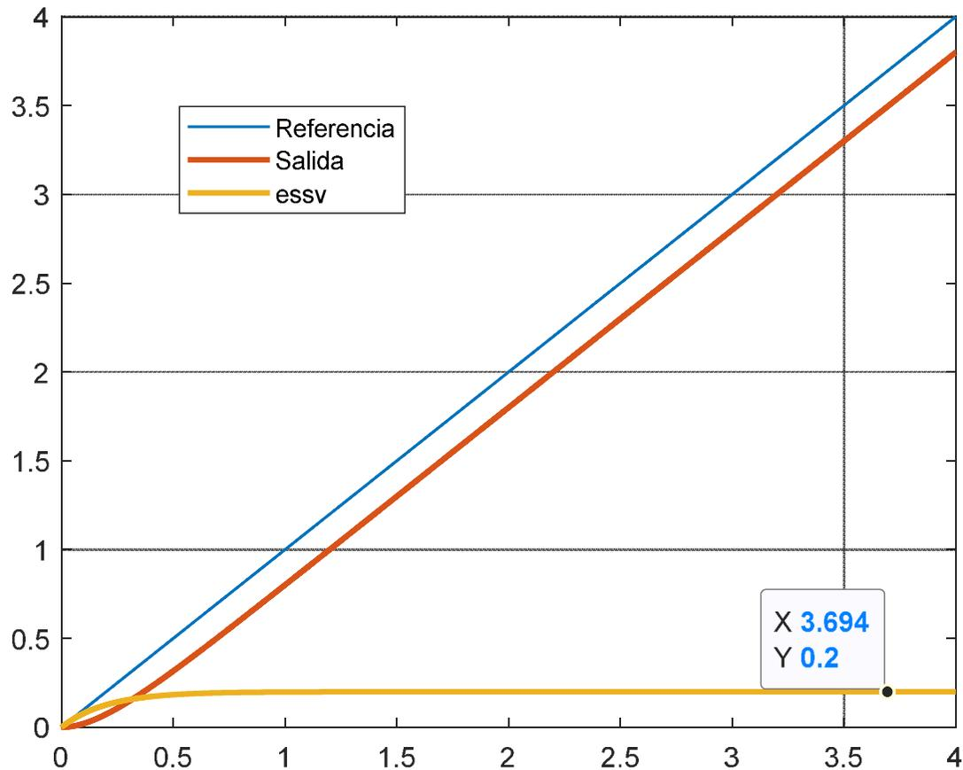
El error de velocidad para entrada en rampa resulta del 20% como exigido en las especificaciones. Esto se debe a la selección del polo real que determina la respuesta.
