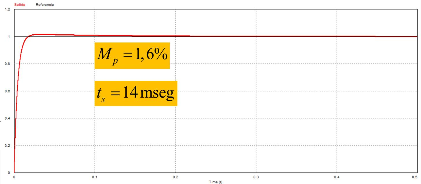
Aquí se observan ambos resultados, obtenidos con la simulación de Matlab y PSIM. En ambas, la acción de control es no limitada. Para obtener este resultado en PSIM debe colocarse un valor elevado de tensión de alimentación de los AMP-OP.
