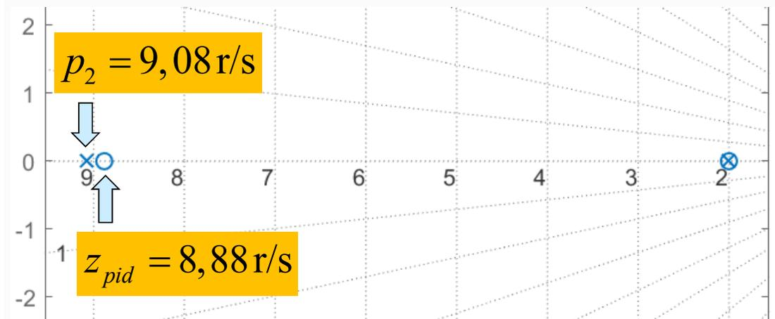
Es posible observar que el polo de LC dominante restante, es prácticamente cancelado por el otro cero del PID, resultando básicamente una respuesta de un sistema de 1er orden, determinada por la ccte. de tiempo del polo  $p_3$ .
