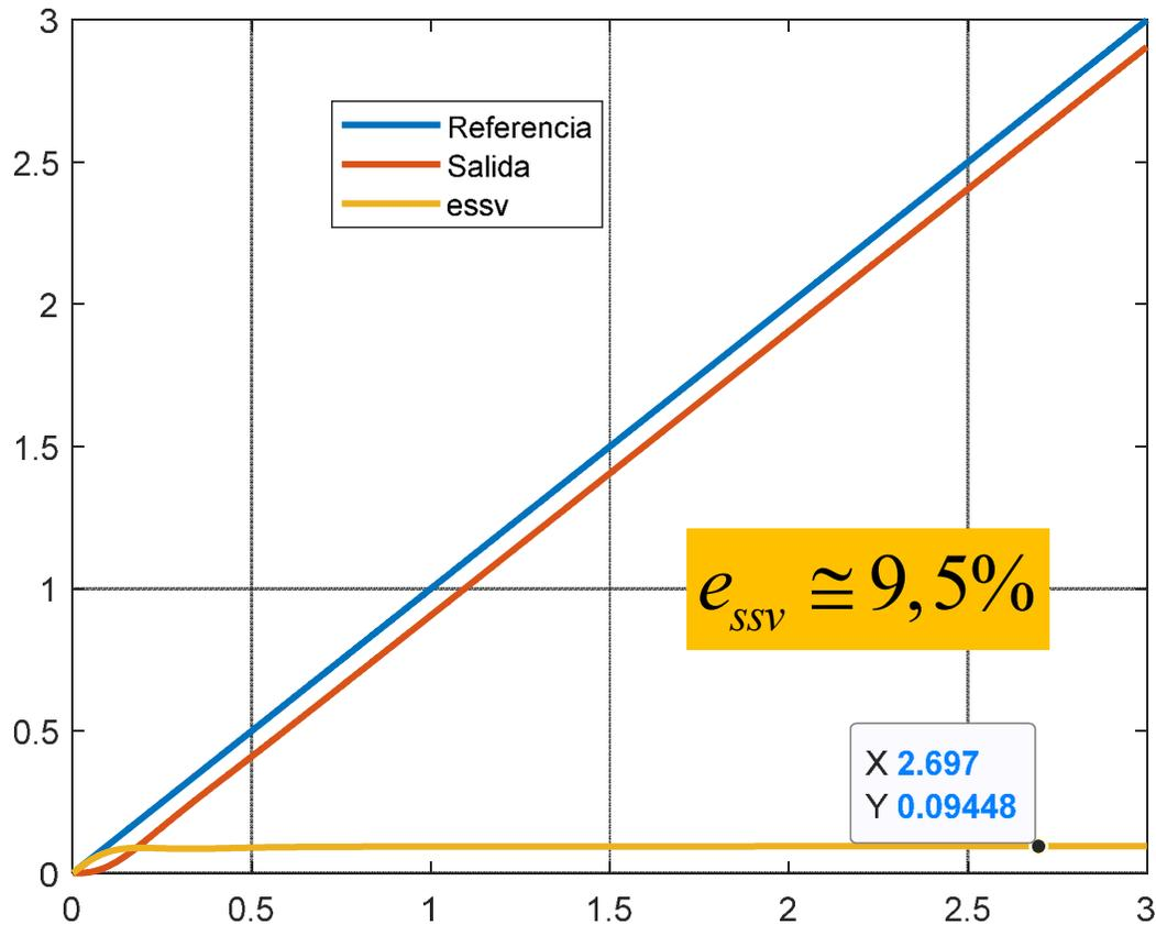
El error para entrada en rampa se reduce de forma importante.
