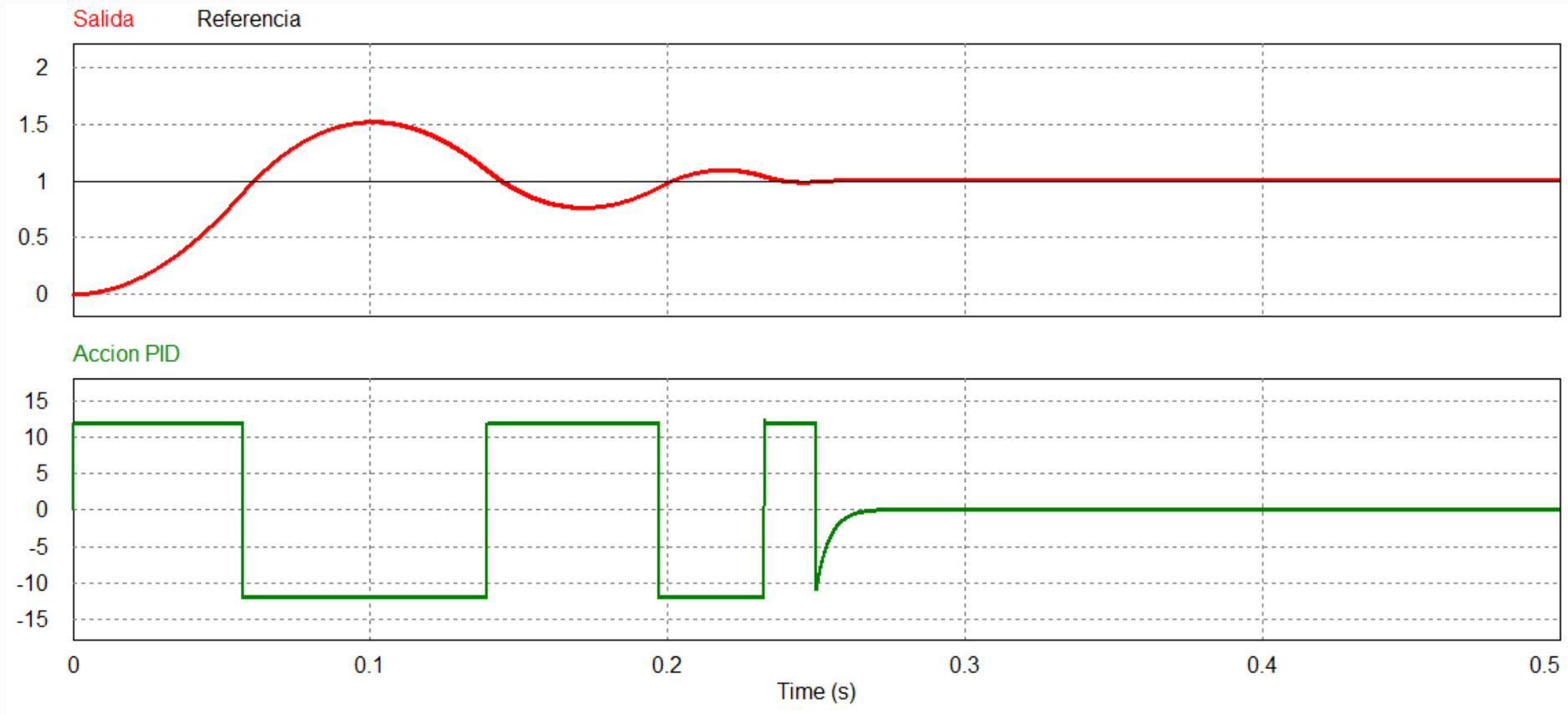
Es importante observar lo que sucede cuando la referencia aplicada es en escalón, la acción de control resulta limitada varias veces por la saturación de los AMP-OP, provocando la oscilación en la salida por el efecto del aumento de la acción integral. A diferencia del resultado obtenido con la simulación de Matlab, **es que en esta última se considera que la acción de control es no limitada.**
