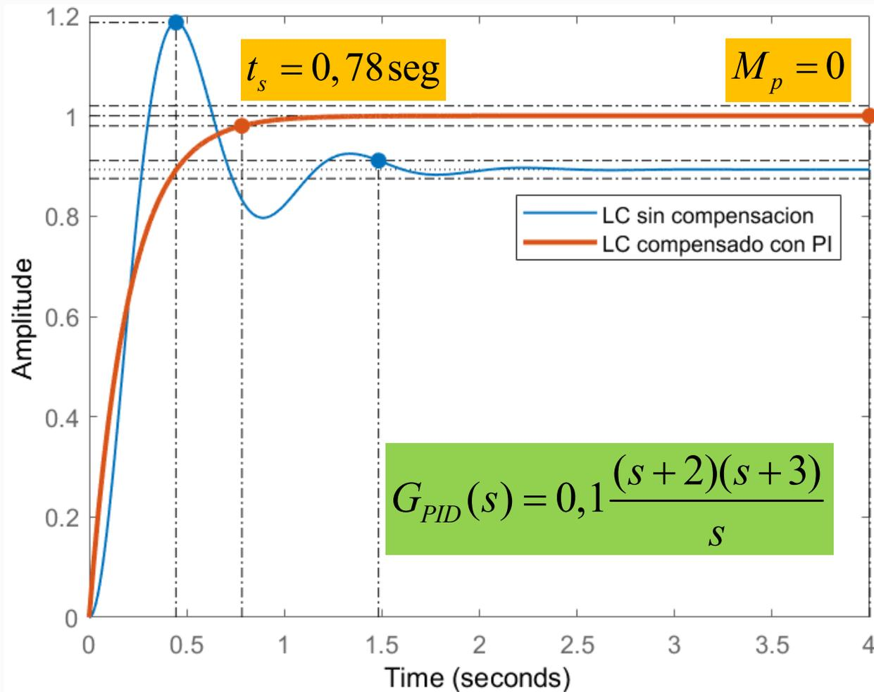
El sobrepaso se reduce a cero por ser de primer orden la FTLC (respuesta sobreamortiguada).
