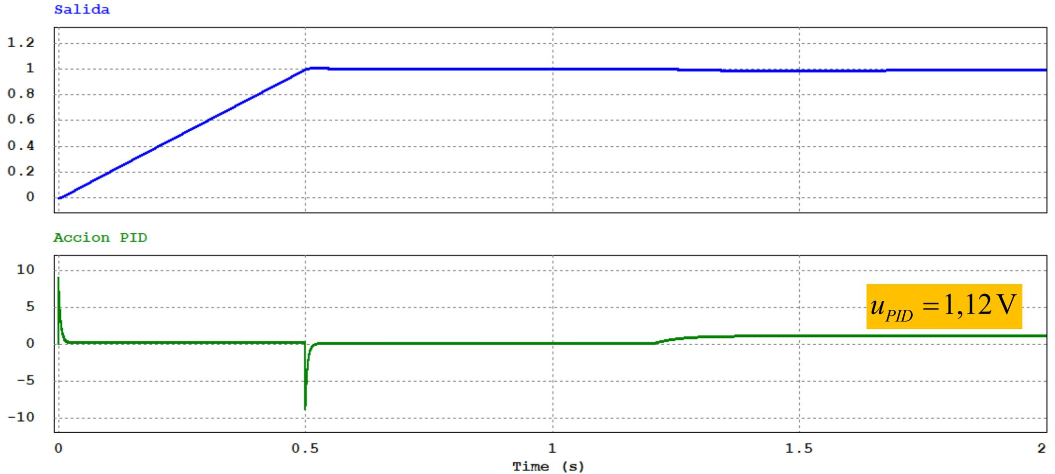
La acción de control no supera los 10 V ni en el arranque ni en el cambio de referencia.
