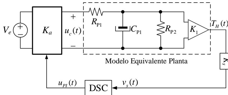
**Figura 1. Esquema de control en LC del horno con actuador PWM.**
