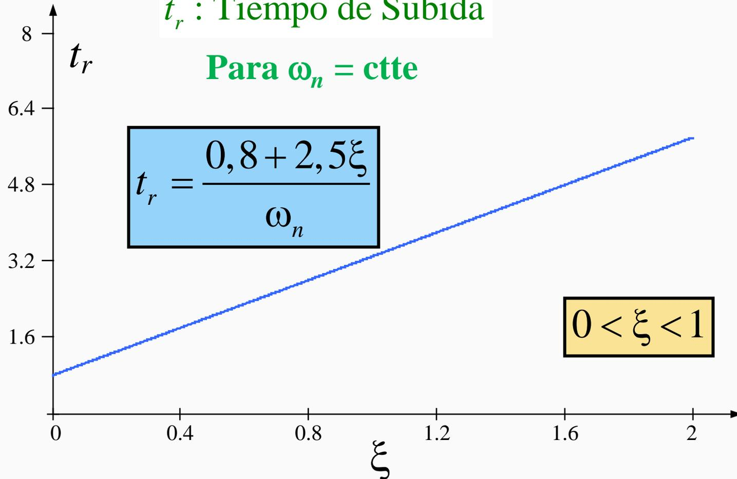
Aproximación lineal y de 2° orden de  $t_r$  para sistemas subamortiguados
