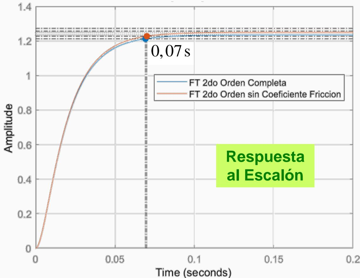
Se observa que el tiempo de asentamiento se da en un valor de 8 veces la constante de tiempo del sistema al despreciarse  $b$ .
