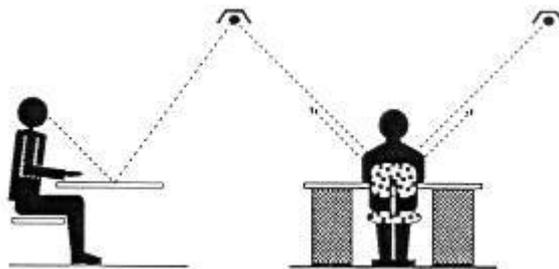
**Fig. 7: Situación de las luminarias en relación con el ángulo de reflexión de la superficie de trabajo**
