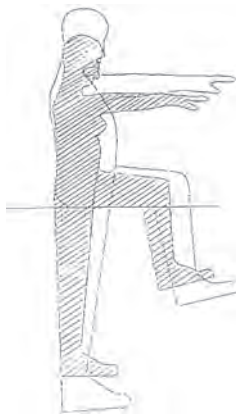
Figura 3.20. Comparación entre la persona más chica, (mujer 5 percentil) y la más grande, (hombre 95 percentil).
