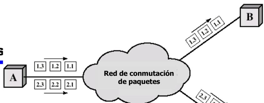
(a) Circuito virtual externo. Se establece una conexión lógica entre dos estaciones. Los paquetes se marcan con un número de circuito virtual y uno de secuencia. Los paquetes se reciben en orden.
