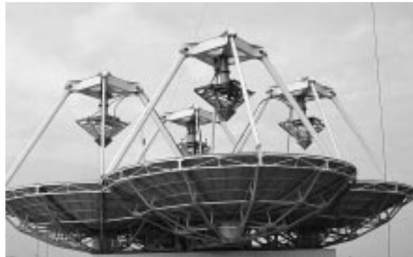
Fig. 7.21 Antenas logoperiódicas trapezoidales dobladas usadas como alimentadores de un reflector
