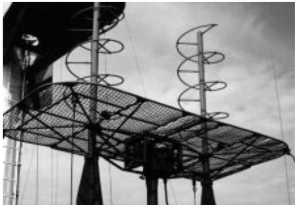
Fig. 7.12 Hélices para comunicación espacial en VHF
