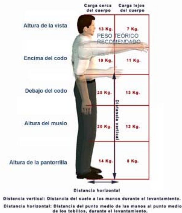
Figura 3. Representación de los posibles valores del Peso Teórico, en función de la zona de manipulación, en condiciones ideales de manipulación.
