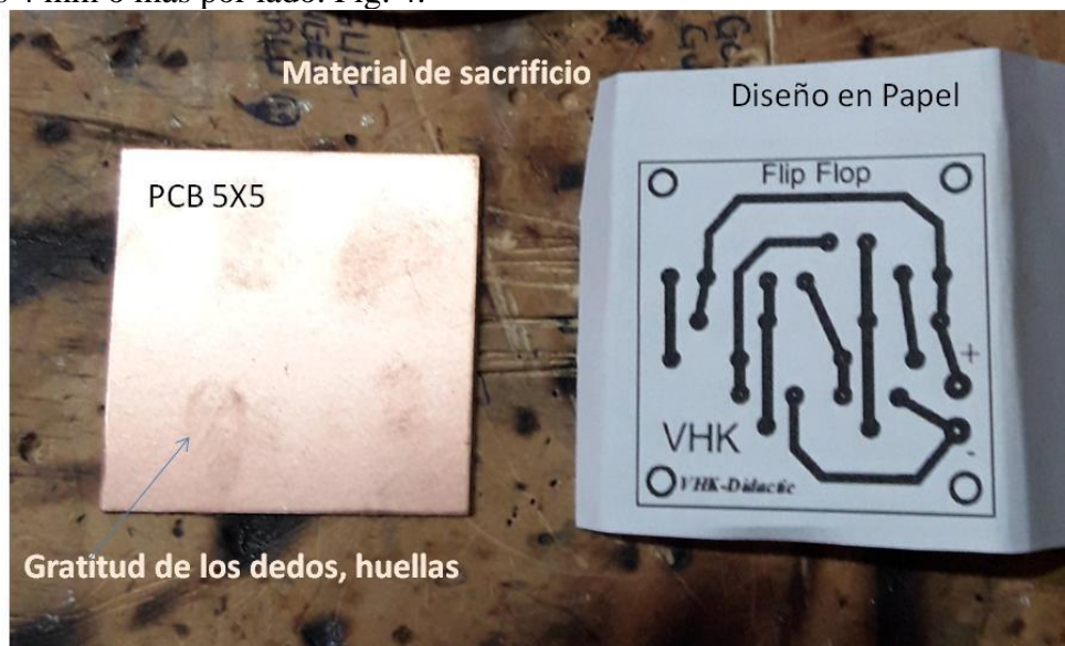
Fig. 4.: PCB – Diseño en papel – Material de sacrificio
