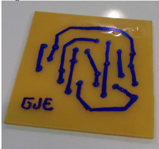
Fig. 12: PCB después del ataque ácido
