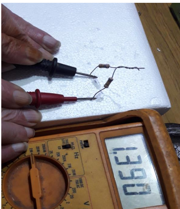
Fig 2.a: Incorrecto – Terminales trenzados
