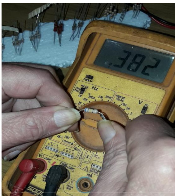
Fig 1.a: Incorrecto – R_{NOMINAL} = 680\text{ k}\Omega
